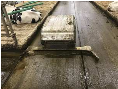
Abbildung 1: Schiebende Entmistungsroboter sind sehr flexibel einsetzbar und können einen erhöhten Fressstand ersetzen.
