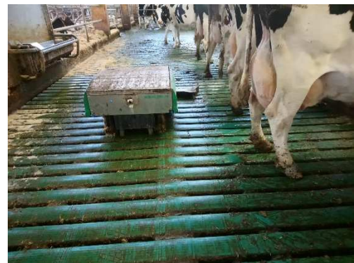
Abbildung 1: Schiebende Entmistungsroboter sind sehr flexibel einsetzbar und können einen erhöhten Fressstand ersetzen.
