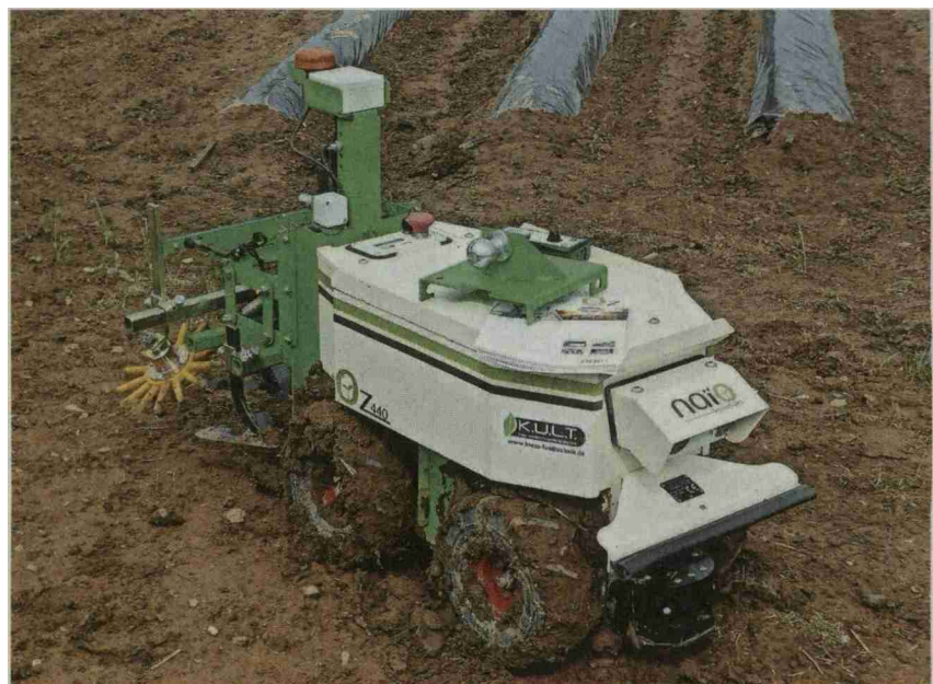
Robotertechnik wird wohl auch im Beerenanbau in Zukunft eine Rolle spielen. Erste Maschinen zur Unkrautbekämpfung waren am Tunneltag zu sehen. Bild: Hagen Thoss
