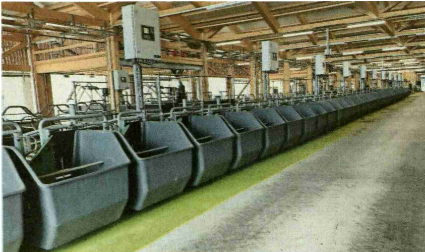
Die Wiegetröge im neuen Milchviehstall von AgroVet-Strickhof in Lindau dienen zur exakten Erfassung des Futterverzehrs. Bild: Matthias Schick
