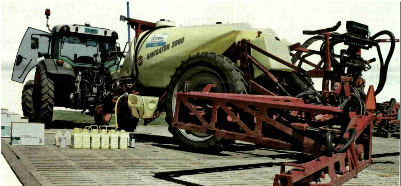
Spritzen mit einem Innenreinigungssystem. Starten und Durchführen des Spülens muss ohne Absteigen vom Traktor möglich sein. Bild: Cauma
