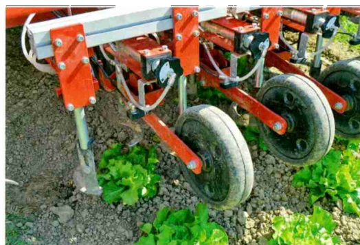
Der Hackroboter von Steketee arbeitet mit kamera gesteuerten Sichelmessern. (Fotos: M. Scheidiger)
