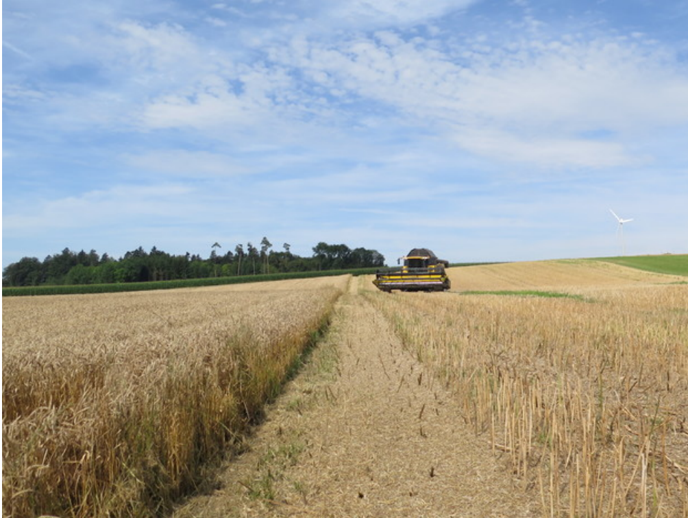
Das Getreide ist gelblich verfärbt. Der Mähdrescher mit einer Schnittbreite von 6,5 Metern zieht seine Spuren ins Feld, in dessen Inneren trennt die Maschine gleich das Spreu vom Weizen. Doch... SRF 2/3
