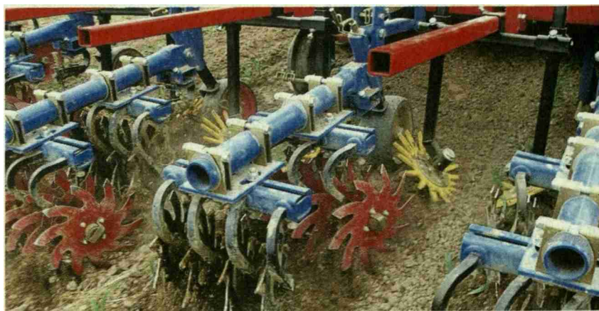
Die Sternhacke kann beim Wegräufeln mit der Fingerhacke kombiniert werden. (Foto: © Hatzenbichler, Firmenfoto)
