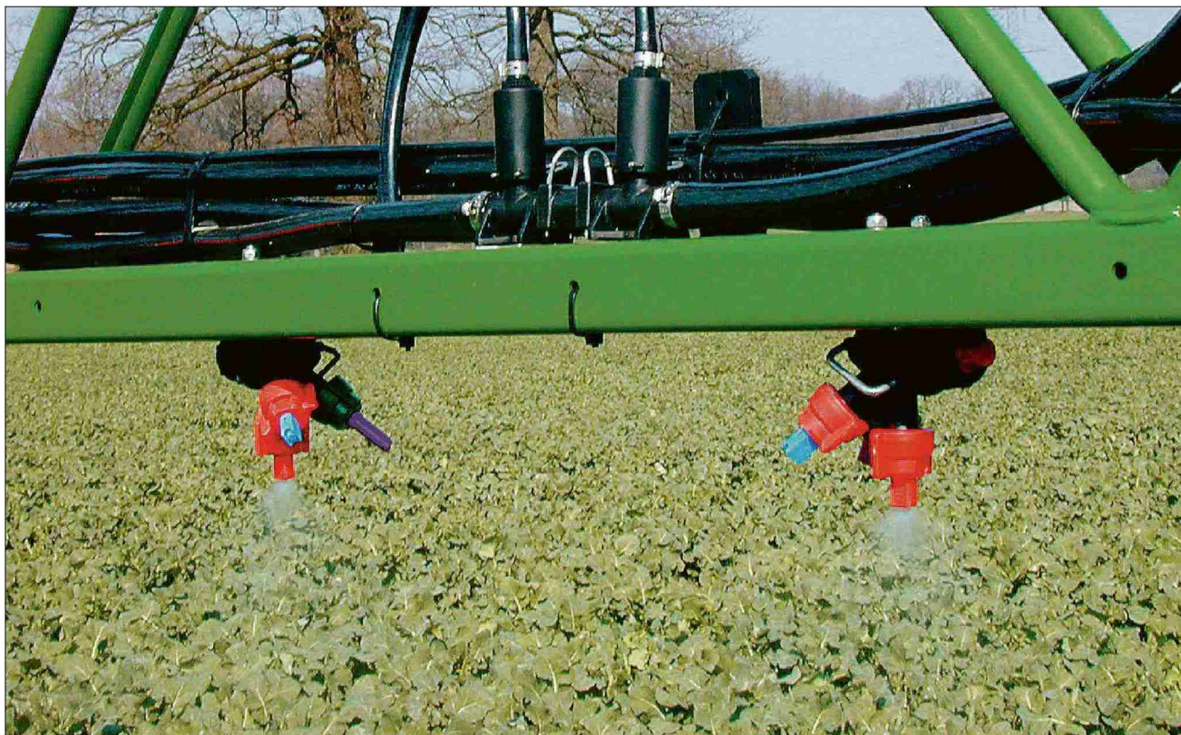
Grosse Tropfen der Injektordüsen vermindern die Abdrift. Injektordüsen sind heute Standard, sie gehören an jede Spritze!
