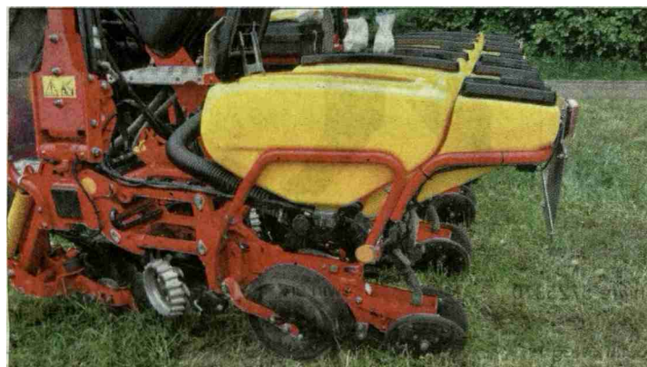
Bei der Einzelkornsämaschine mit Saatbanddüngung ist ein Behälter für das Dünger-Mikrogranulat angebracht.
