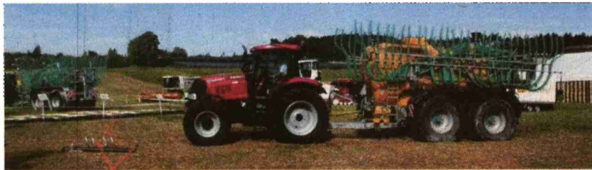
Schleppschlauchverteiler ermöglichen eine emissionsarme Ausbringung der Gülle. (Bild: S. Berger, Strickhof)
